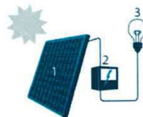
1: Zonnepaneel | 2: Omvormer | 3: Elektrische toestellen
